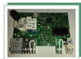
Controlo eletrónico 2ª zona com válvula misturadora
